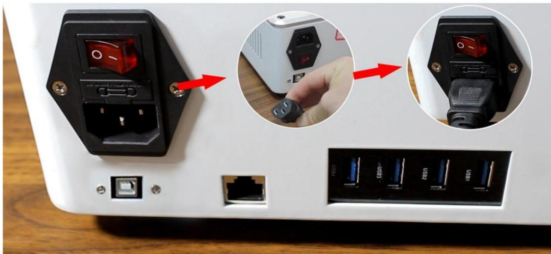
(2) Conecte o cabo da fonte de alimentação e a rede entre o computador e a máquina, o cabo do mouse e o cabo do teclado podem ser conectados a qualquer uma das portas USB.
